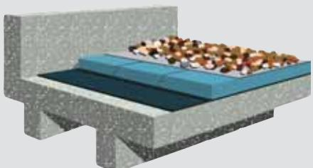
**Firestone Inverzni Sistem** je varijanta konvencionalnog Sistema sa Balastom idealna za prohodne krovove i/ili za surove klimatske uslove. Veliki EPDM paneli se razdvajaju od balasta slojem vodootpornih termoizolacionih ploča i geotekstilom slobodno položenim preko membrane.
